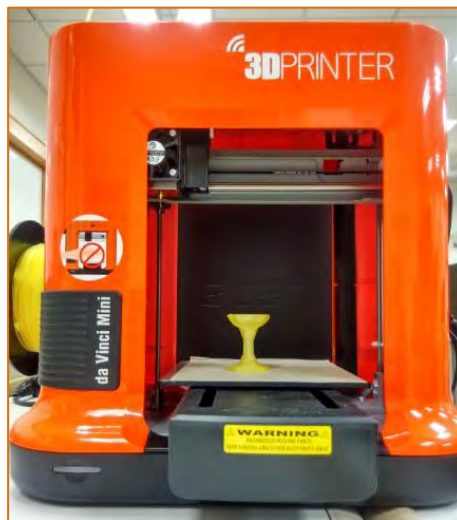
圖 18 3D 印表機列印裝藥杯
